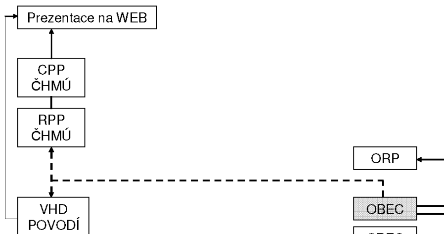
Schéma přenosu informace o vodních stavech v hlásném profilu na území obce (při nebezpečí povodně a za povodně)
